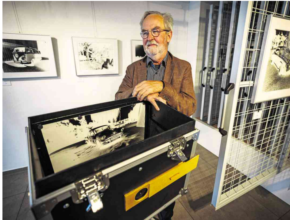
Die Camera obscura hat Alexander Riffler aus einer Transportbox gebaut. Vorne ist der Schieber, mit dem das kleine Loch für den Lichteinfall bedeckt oder freigelegt wird. Foto: Gottfried Stoppel
